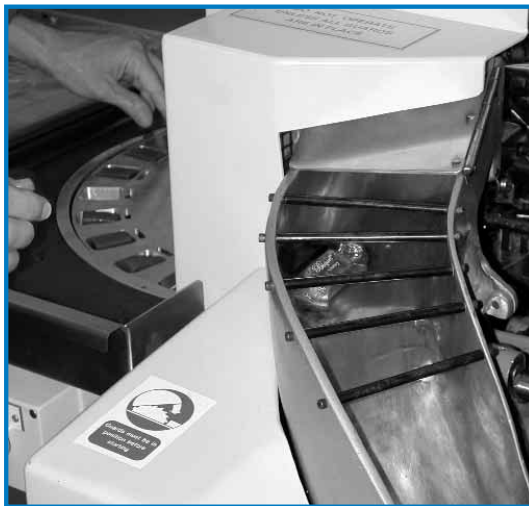
Machine wraps 90 caramels per minute.
